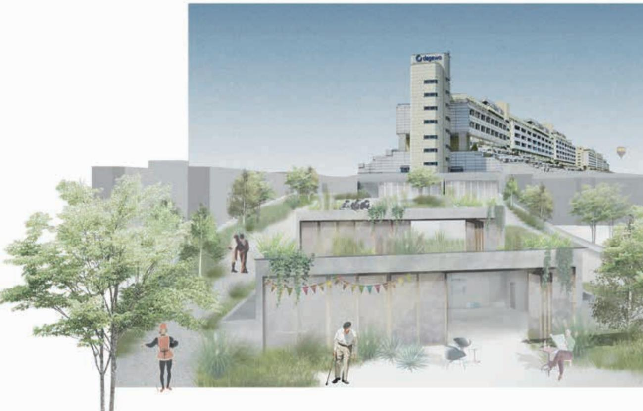
Die Arbeit zeigt eine Möglichkeit der Nachnutzung der bestehenden Brücke auf. Der Überbau und die Pfeiler bleiben erhalten. Wo nötig, wird die bestehende Struktur verstärkt. Durch die Vielzahl der erforderlichen Unterstützungen entsteht allerdings der Eindruck, dass das vorhandene Brückendeck einen Ballast darstellt. Da die zusätzlichen Unterstützungen die Möglichkeiten des vorgespannten Hohlkastens nicht gezielt erweitern, verliert dieser seine Daseinsberechtigung.
